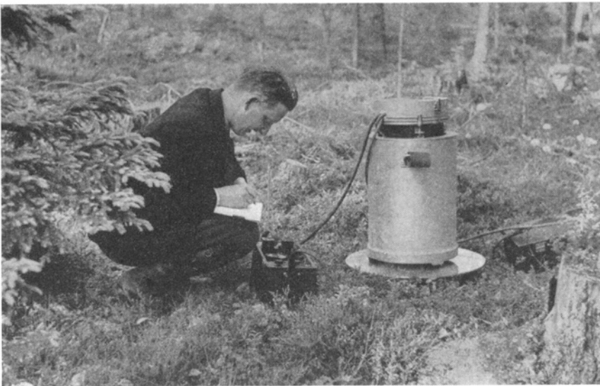
Fig. 28. Mätning med gravimeter av Lindblad-Malmqvist-typ.
