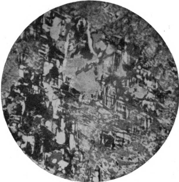
Fig. 3. Skapolitisering av mikroklin. Holt pr. Tvedestrand. Mikro-foto. Nicols + Forstørr. 17. J. Sch. fot.
