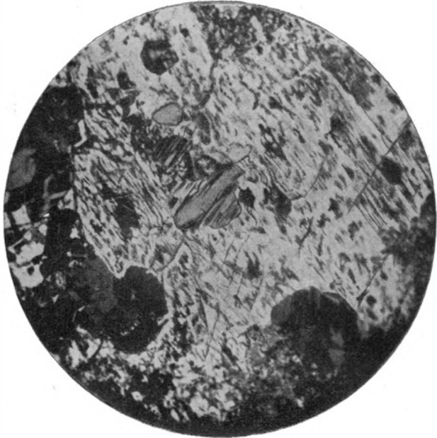
Fig. 4. Skapolit- og muskovitdannelse i mikroclin. Holt pr. Tvedestrand. Mikro-foto. Nicols + Forstørr. 29. J. Sch. fot.
