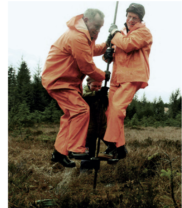
Forskere borer etter spor av en 8100 år gammel tsunami (Storegga-skredet) i en myr på Askøy ved Bergen, og dokumenterer hvor høyt flodbølgen lokalt slo inn over land. Slike studier er viktige for beregning av mulige konsekvenser ved fremtidige flodbølger. (Foto: H. Hansen)
