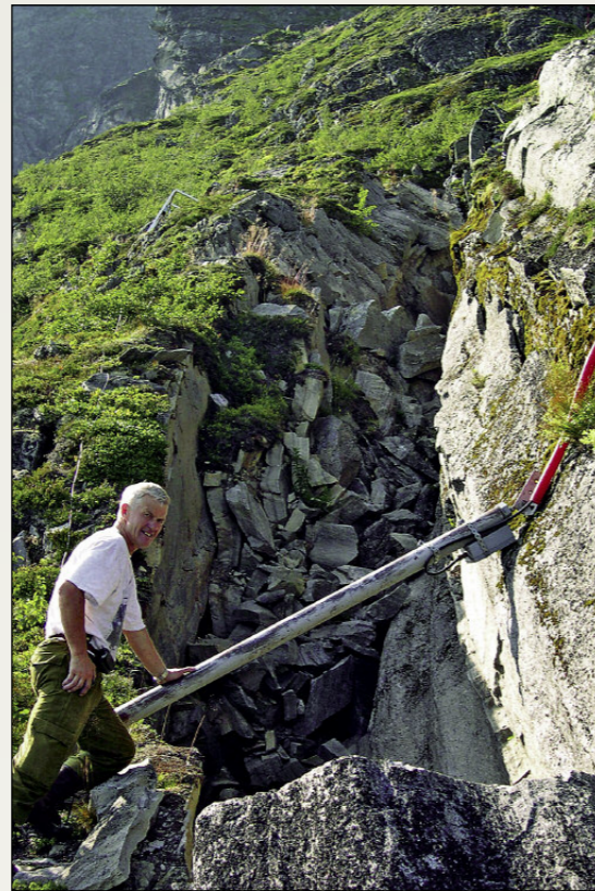
Strekstag er montert i sprekke på Åknes for å kunne måle utvidelsene kontinuerlig. (Foto: L.H. Blikra)
