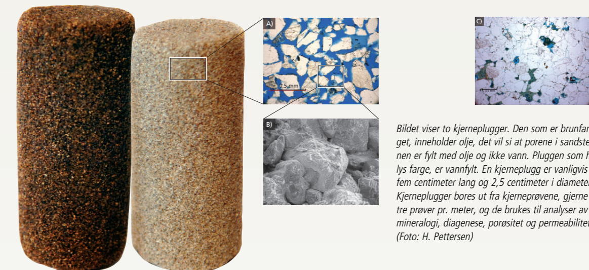
A) Tynnslipbilde av en meget porøs sandstein fra den tidligjuraiske Åreformasjonen på Haltenerrassen. Sandkornene er kvarts og i noen få tilfeller kalifeltspat. Lavt begravingsdyp (1,7 kilometer) og lav temperatur gjør at sandsteinen ikke inneholder kvartssement. Porøsiteten er 33 prosent og permeabiliteten er 5,1 darcy. B) Elektronmikroskopbilde som viser sandkornene og porefyllingen i meget stor detalj. Sandkornene er kvarts med små mengder kvartssement som viser godt utviklede krystallflater. De lyse trådene er leirmineraler, som kun finnes i små mengder i denne prøven. C) Tynnslipbilde av sterkt kvartssementert sandstein fra den midtjuraiske Garnformasjonen på Haltenerrassen. Alle sandkornene består av kvarts, og porene er delvis fylt med diagenetisk illitt. Den sterke kvartssementeringen skyldes at sandsteinen har vært dypt begravd og utsatt for høy temperatur over lang tid, henholdsvis fire kilometer og 160 grader. Porøsiteten er fem prosent og permeabiliteten er 0,1 millidarcy. (Alle foto: Statoil)
