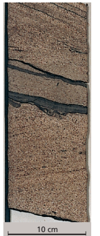
Borkjerne fra Ileformasjonen på sørlige Haltenterrassen. Bildet viser skråsjiktet sandstein avsatt i en elvekanal fra 6506/12-1. (Foto: Statoil)
