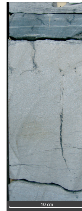
Borkjerne fra Nordmelaformasjonen i Hammerfestbassenget. Kjernen er fra brønn 7120/8-1, fra Hammerfestbassenget, og viser sandstein med rotspor. (Foto: E.P. Johannessen)
