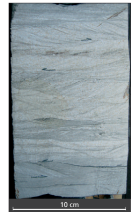
Borkjerne fra Nordmelaformasjonen i Hammerfestbassenget. Bildet viser sandstein med riflelagning i brønn 7119/12-1. Noen av riflelagene går i motsatt retning. Slik lagning kalles fiskebeinslagning og dannes av motgående tidevannsstrømmer. (Foto: E.P. Johannessen)
