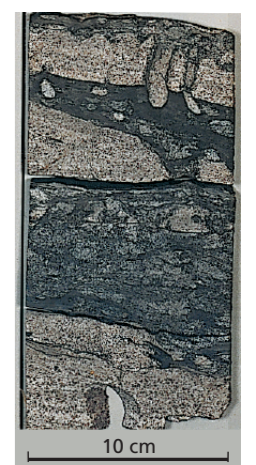
Borkjerne fra Ileformasjonen i brønn 6506/12-1, på Haltenterrassen. Bildet viser lagdelt sandstein og slamstein, med vertikale og horisontale gravespor. (Foto: Statoil)
