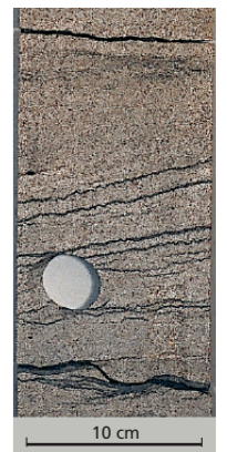
Borkjerne fra Garnformasjonen i brønn 6506/12-1, på Haltenterrassen. Bildet viser skråsjiktet sandstein. De parvise, mørke båndene er slam og kalles av geologene for doble draperinger. De er typisk for tidevannsstrømmer og avsettes i den rolige perioden når tidevannsstrømmene snur. (Foto: Statoil)
